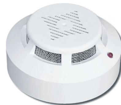
распространяется вдоль него. Несмотря на всю простоту устройства, извещатель требует к себе определенного внимания. Минимум раз в год требуется менять батарейки. И периодически, как минимум раз в полгода, снимать и продувать пылесосом камеру с оптико-электронным датчиком, чтобы избежать ложных срабатываний от осевшей пыли.
