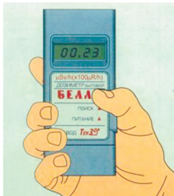
Имейте бытовые дозиметры и умейте ими пользоваться. С их помощью определяйте радиационную обстановку на местности, степень радиоактивного загрязнения продуктов питания и кормов
